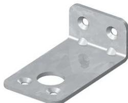
**OLY CONNECT STEEL L** es una placa en L de acero pregalvanizado reforzada con nervaduras. Presenta cuatro orificios avellanados y un orificio grande de 16 mm de diámetro. Puede adherirse a elementos metálicos mediante el uso del mortero epoxi OLY RESIN 10 HTG, marcado CE conforme a la norma EN 1504-4.
