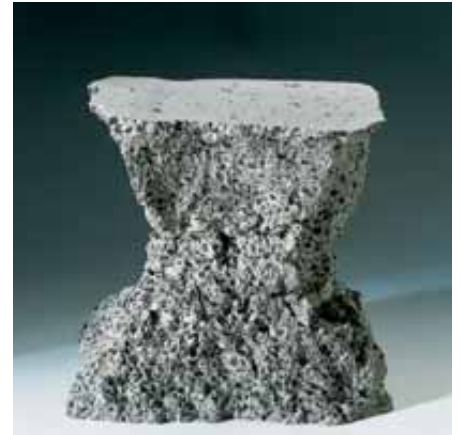
Rotura de probeta cúbica para determinar la resistencia a la compresión.
