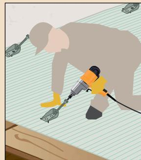
Los conectores metálicos se disponen de forma simétrica con respecto a la línea media central del forjado con la parte vertical orientada hacia las paredes y la flecha dirigida hacia el centro del forjado.
