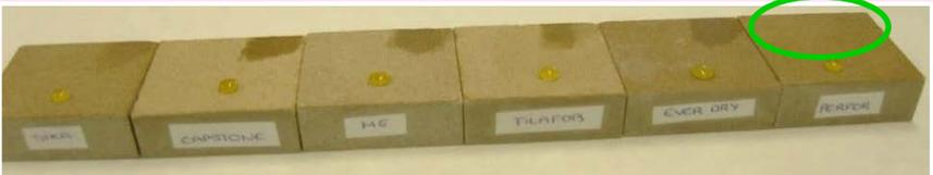
**TECNADIS PRS PERFORMANCE** cumple las especificaciones contempladas en las normas UNE- EN 16301, UNE-EN 14527; 2006+A1 "Determinación de la sensibilidad a las manchas". Norma ISO 11998- DIN EN13330-ASTM D2486,D3450,D4213,D4828 "Resistencia abrasión"
