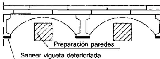
1. Sanear vigueta deteriorada y preparación de las paredes para colocación del soporte.
